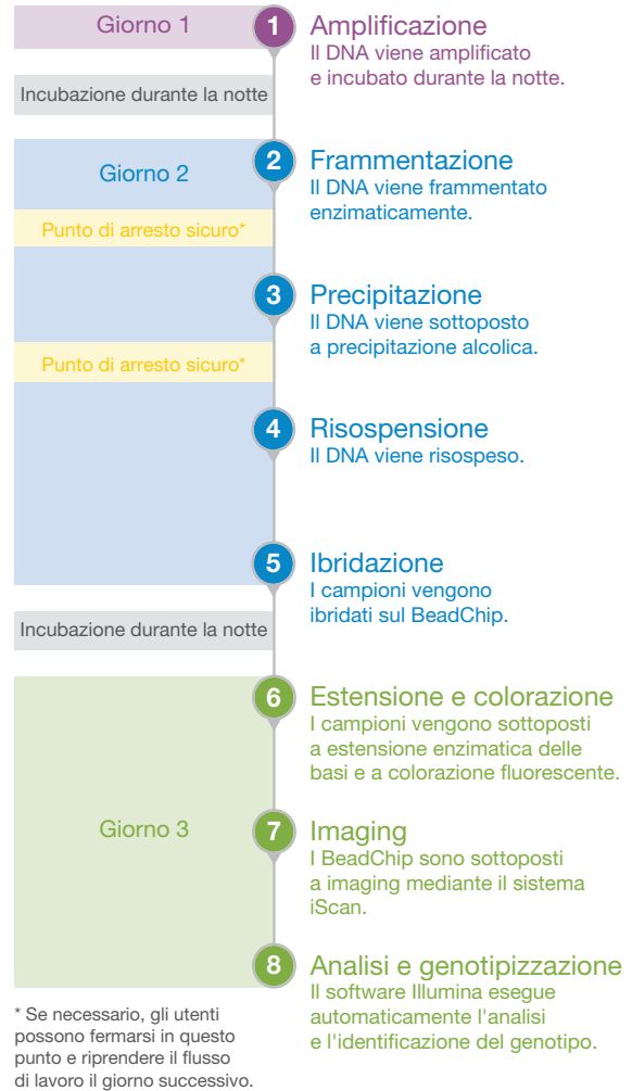
Figura 8: Flusso di lavoro di Infinium nel formato a otto campioni: il formato di Infinium offre un rapido flusso di lavoro di tre giorni con interventi manuali minimi.
