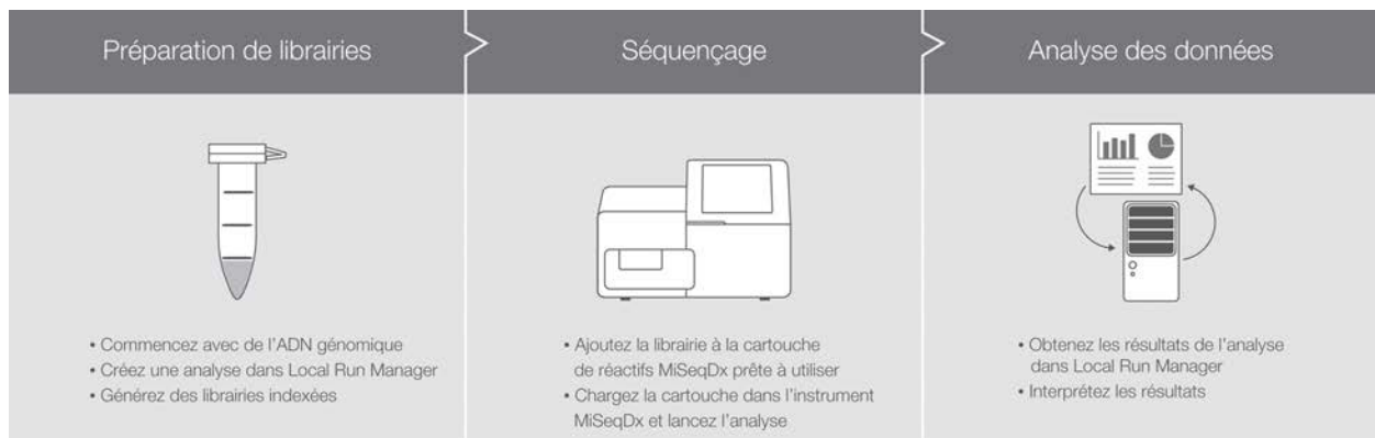
Figure 2 : Processus de réalisation de tests en trois étapes de l'instrument MiSeqDx : l'instrument MiSeqDx fait partie d'un flux de travail intégré en trois étapes. Les rapports de résultats détaillés sont uniquement disponibles pour les tests ayant des objectifs bien précis, comme le panel RAS étendu, le test de 139 variants de la fibrose kystique TruSight et le test de séquençage clinique de la fibrose kystique TruSight.
