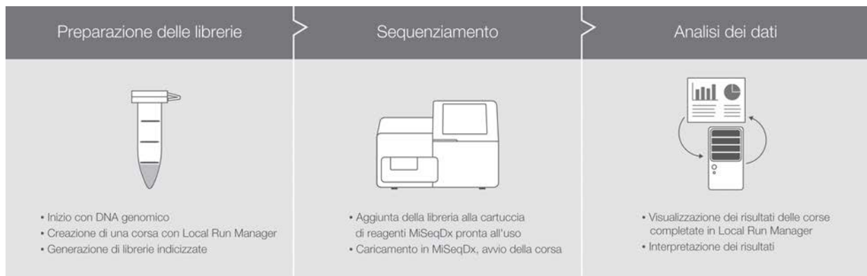
Figura 2: Procedura in tre fasi del saggio MiSeqDx: lo strumento MiSeqDx fa parte di una procedura integrata in tre fasi. I report dettagliati sui risultati sono disponibili solo per i saggi specifici per i target, come pannello Extended RAS, saggio TruSight Cystic Fibrosis 139-Variant e il saggio TruSight Cystic Fibrosis Clinical Sequencing.
