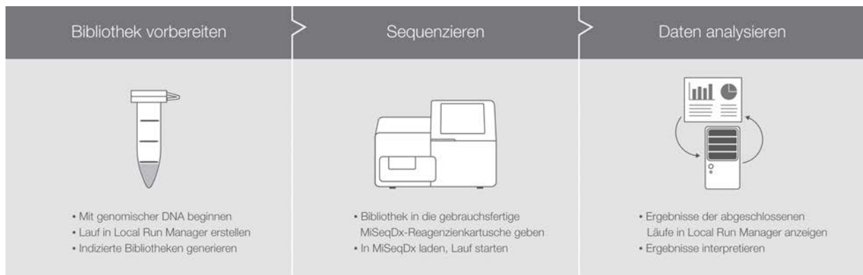
Abbildung 2: Dreistufiger MiSeqDx-Assay-Prozess: Das MiSeqDx-Gerät ist Teil eines integrierten, dreistufigen Prozesses. Detaillierte Ergebnisberichte sind nur für Target-spezifische Assays, z. B. das Extended RAS Panel, den TruSight Cystic Fibrosis 139-Variant Assay und den TruSight Cystic Fibrosis Clinical Sequencing Assay, verfügbar.
