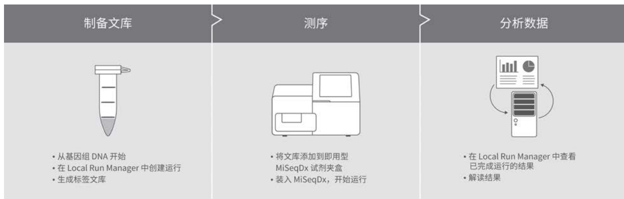
图 2：三步 MiSeqDx 实验分析方法流程 — MiSeqDx 仪器是集成的三步流程的一部分。仅对于特异性目标的实验分析方法（例如 Extended RAS Panel、TruSight 囊胞性纤维症 139 变异实验分析方法和 TruSight 囊胞性纤维症临床测序实验分析方法），会提供详细的结果报告。
