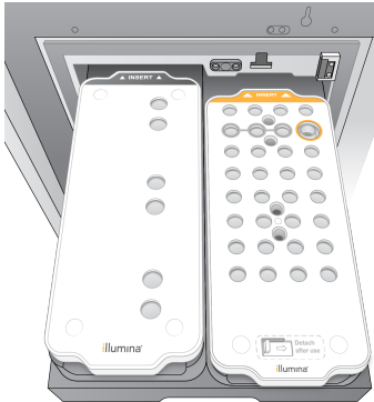
Figura 9 Cartușe cu reactivi încărcate
