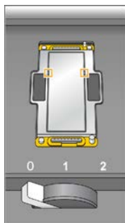
Abbildung 8 Überprüfen der Vakuümöffnungen
