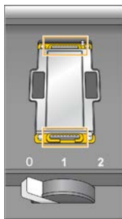
Abbildung 22 Entfernen der gebrauchten Manifold-Dichtungen
