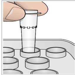
Abbildung 22 MiSeq-Röhrchen in Position 17 der Waschablage
