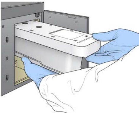
Figura 15 Carga del cartucho de tampones
