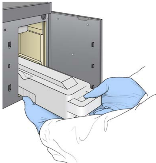
Figura 13 Retirada del contenedor de reactivos usados
