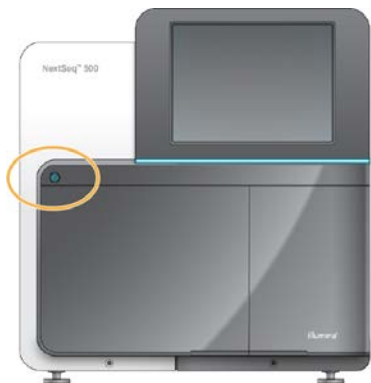
Рисунок 8 Кнопка питания расположена на передней панели прибора
