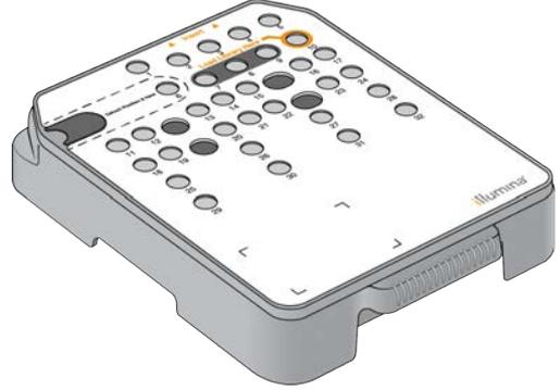
تحتوي خرطوشة الكاشف على خزان مخصص لتحميل المكتبات المجهزة. بعد بدء التشغيل، تُنقل المكتبات تلقائيًا من الخزان إلى حجرة التدفق. يُحفظ العديد من الخزانات لإجراء غسيل تلقائي بعد التشغيل. يُضخ محلول الغسيل من خرطوشة التخزين المؤقت إلى الخزانات المحفوظة، عبر النظام، ثم إلى حاوية الكواشف المستعملة.
