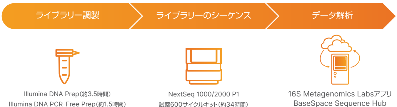
図1: 16Sメタゲノミクスシーケンスワークフロー: 16Sシーケンスワークフローは、ライブラリー調製、シーケンス、二次データ解析を含みます。NextSeq 1000/2000 P1試薬600サイクルキットのシーケンスランタイムは約34時間であり、NextSeq 1000/2000 P2試薬600サイクルキットのランタイムは約44時間です。
