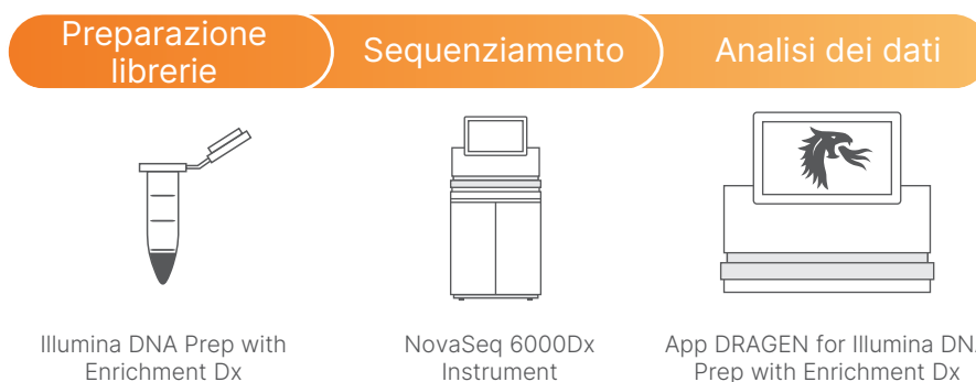
Figura 1: flusso di lavoro di identificazione di varianti. Il NovaSeq 6000Dx Instrument fa parte di un flusso di lavoro integrato costituito da tre fasi che include preparazione delle librerie, sequenziamento a elevata processività, sia in modalità IVD sia in modalità RUO, e analisi dei dati secondaria accelerata grazie a un DRAGEN Server associato.
